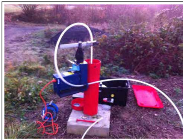
Prélèvement d'eau dans un piézomètre.
